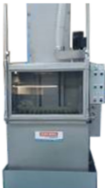
Säkerhetstank under maskinen.
