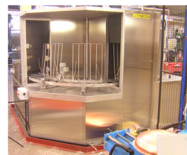
Roterande tunneltvätt som hämtar och lämnar gods i samma punkt
