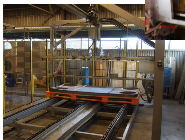
Tunneltvätt med kedjetransportör och linjär robot
