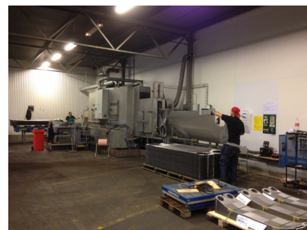
Tunneltvätt med kedjebana om 4 steg
