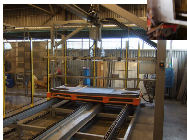
Tunneltvätt med kedjetransportör och linjär robot
