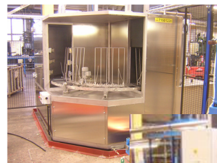
Roterande tunneltvätt som hämtar och lämnar gods i samma punkt
