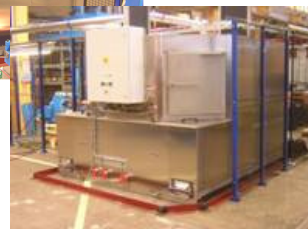
Roterande tunneltvätt som hämtar och lämnar gods i samma punkt
