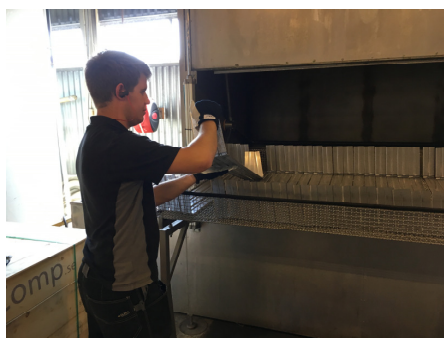
Flerstegs spoltvätt med utbytbara fixturer för att hantera olika typer av gods.
