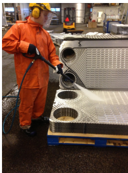
Manuell högtryckstvätt, separat eller som komplement till övriga maskiner
