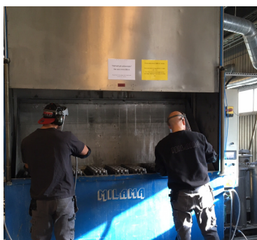
Dopptvätt med jacuzzispolning, vätskefiltrering och möjlighet till manuell spolning.
