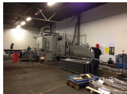
Tunneltvätt med kedjebana om 4 steg
