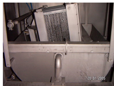
Rotation av korg i vätsteg och tork. Vinkel och hastighet är steglöst justerbart.
